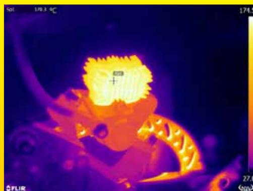
Avec EXOTherm2, les températures du système de freinage sont considérablement inférieures à celles des plaquettes standard, ce qui réduit l'usure des plaquettes et des disques. Des températures plus basses signifient également des performances de freinage plus constantes tout en réduisant la décoloration des freins et la réduction de la puissance de freinage causée par la surchauffe des composants.
